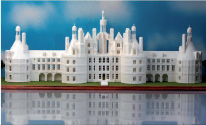
Aus lasergesintertem Mehrkomponenten-Polyamidpulver: Architekturmodell, SLS-gedruckt von 3D Systems. [Foto: 3DSmart.com.ua]
